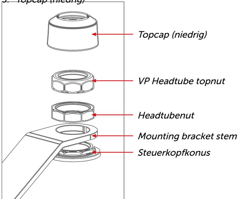
**Schritt 4:** Drehen Sie den *Headtubenut* und den *VP Headtube topnut* an, montieren Sie den *Topcap*, bringen Sie den Lenkervorbau wieder an und drehen Sie den Lenkervorbau in der richtigen Position fest. Gehen Sie zur Seite 5 für die Montage des Korbes.
