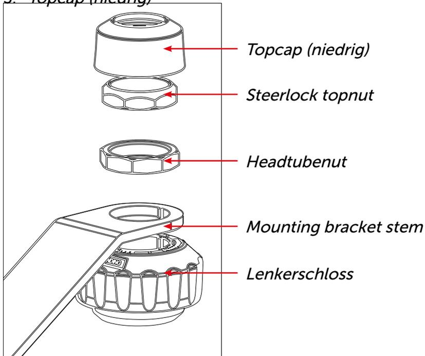
**Schritt 4:** Drehen Sie den *Headtubenut* und den *Steerlock nut* an, montieren Sie den *Topcap*, bringen Sie den Lenkervorbau wieder an und drehen Sie den Lenkervorbau in der richtigen Position fest. Gehen Sie zur Seite 5 für die Montage des Korbes.
