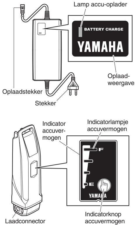
De meegeleverde accu voor de Yamaha e-Bike Systems is een lithium-ion accu. De lithium-ion accu is licht en biedt een superieure capaciteit. Het heeft echter wel de volgende kenmerken.
